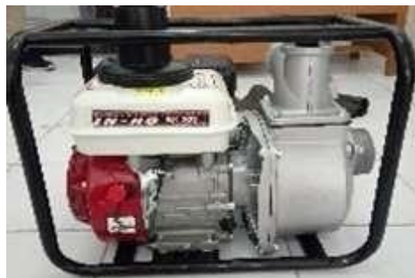
Gambar 5. Pompa Air Sawah
