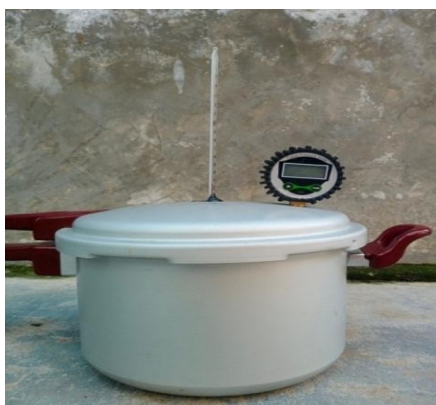
Gambar 1. Alat pengujian Alat untuk mengetahui temperatur dan suhu pada simulasi pembakaran cairan EM-4 dan jerami padi dan tanpa campurannya kotoran sapi dengan air.
